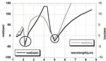
(b) Partie réelle des paramètres homogénéisés
