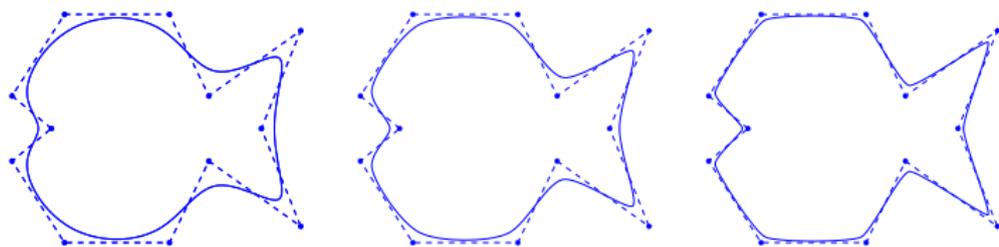
En chaque nœud, matrice de connexion  $M = \begin{bmatrix} 1 & 0 \\ b & 1 \end{bmatrix}$ , avec, de gauche à droite  $b = 0 ; 4 ; 16$ .
