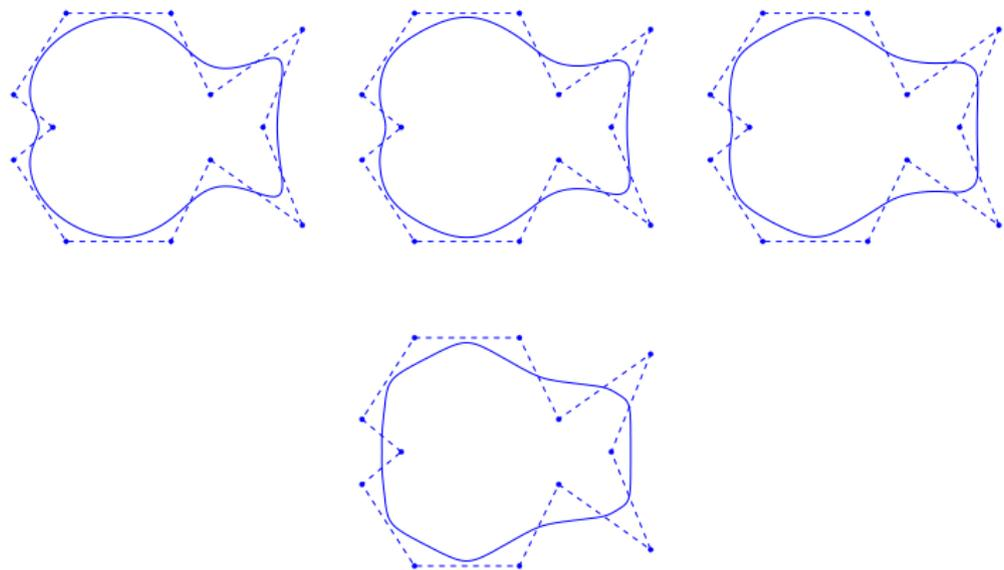
En chaque nœud, matrice de connexion  $M = \begin{bmatrix} 1 & 0 \\ b & 1 \end{bmatrix}$ , avec, de gauche à droite  $b = -1 ; -2 ; -3 ; -3,9$ .
