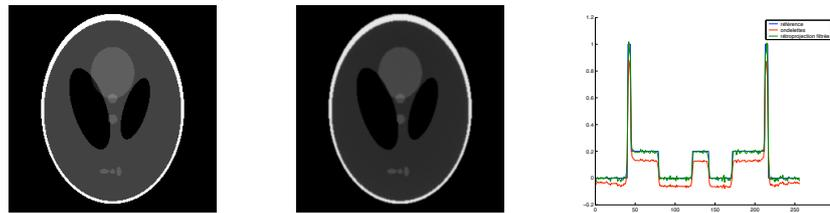
FIG. 2 – Le fantôme de Shepp Logan : image originale (à gauche), reconstruction par la formule d’inversion utilisant les ondelettes (au centre), coupe horizontale au milieu de l’image (à droite) [4]. Le changement d’intensité dans les niveaux de gris s’explique par la perte de la valeur moyenne de l’image.
