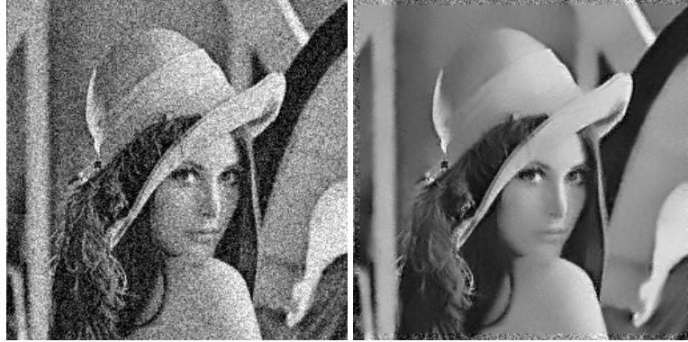
FIG. 6 – Exemple de débruitage par NL-means. A gauche, image Lena à laquelle on a ajouté un bruit gaussien d’écart-type \sigma = 30 . A droite, image débruitée par NL-means avec un paramètre d’échelle h = 20 , et une fenêtre V de taille 11 \times 11 .
