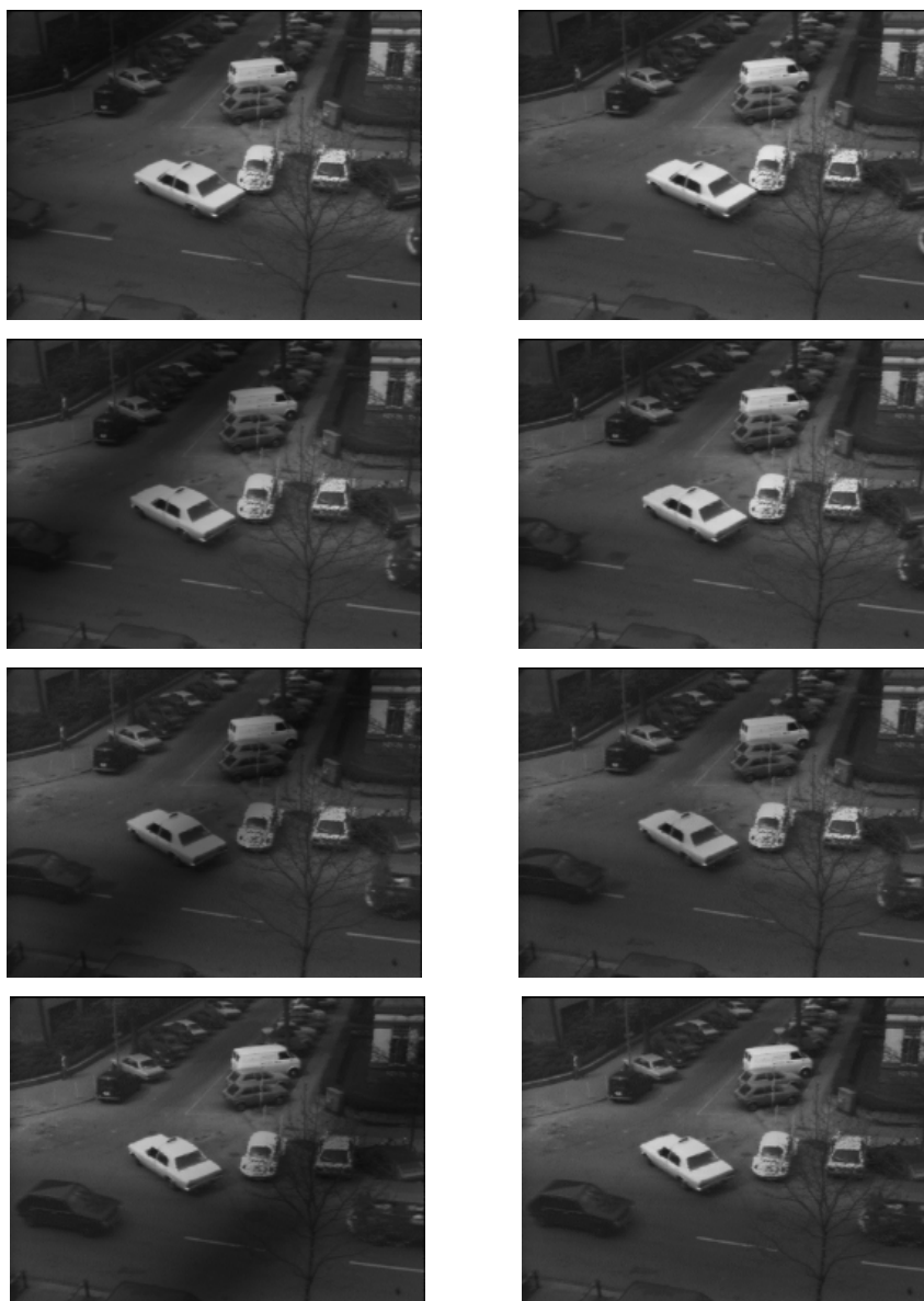
FIG. 11 – Colonne de gauche : quatre images de la séquence taxi à laquelle on a ajouté un flicker local artificiel. Le flicker a été augmenté ici pour permettre sa visualisation sur des images fixes. Colonne de droite : images obtenues après correction du flicker par la formule (5).
