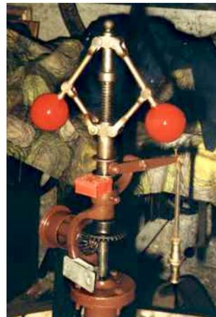
FIG. 6 – Dispositif de Watt.
