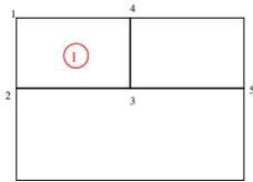
Par exemple, en prenant les notations de la figure ci-contre, on impose que les coordonnées du point  $x_3$  est tel que  $\vec{x}_3(t) = \frac{1}{2}(\vec{x}_2(t) + \vec{x}_5(t))$ ,  $\forall t$ . On a alors, pour la maille 1,
