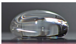
Figure 1: Goutte d'eau d'environ 8mm de diamètre sur une plaque chauffante à plus de 200°C.
